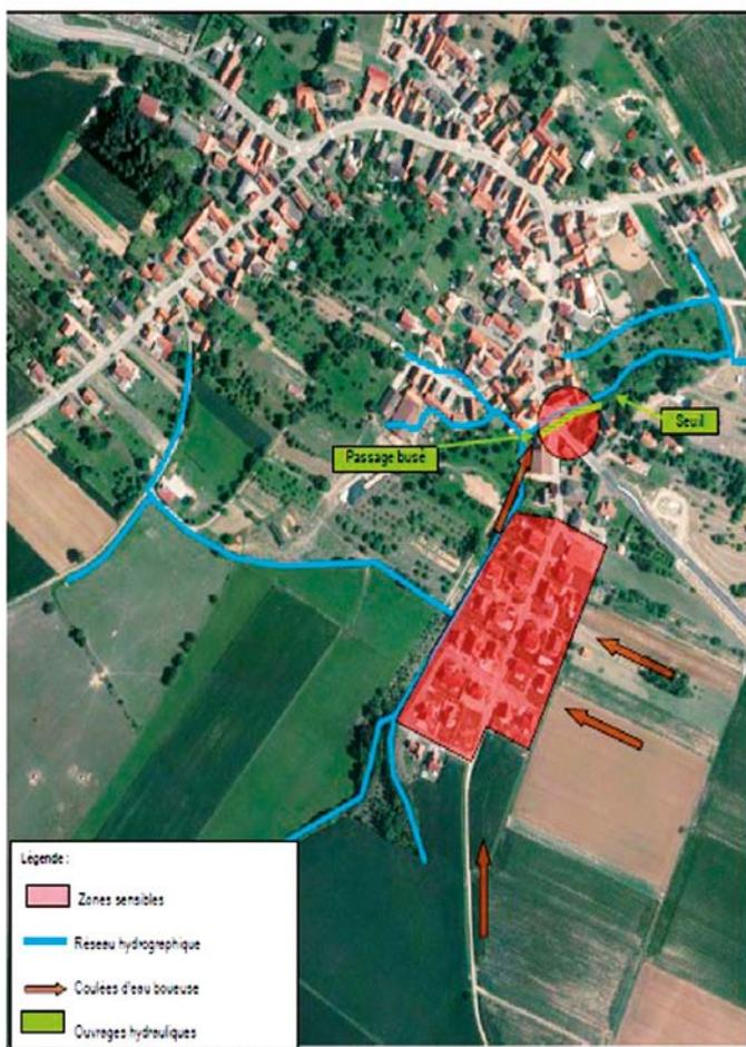
Figure 1-2 : Localisation des zones sensibles aux inondations par coulées d'eau boueuse
